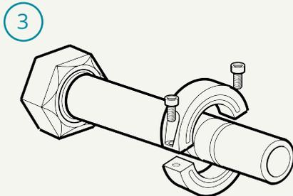
Cierra las dos mitades del anillo completamente. El anillo de Merus puede ser ligeramente más grande que la tubería. Sin embargo, debe cerrarse completamente.
