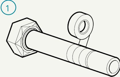
Envuelve la tubería de agua con **cinta aislante**, donde se instalará el Anillo de Merus.
