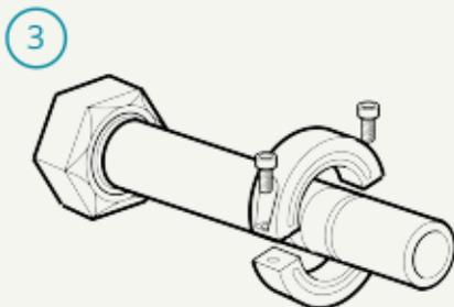
3 Cierra las dos mitades del anillo completamente. El anillo de Merus puede ser ligeramente más grande que la tubería. Sin embargo, debe cerrarse completamente.
