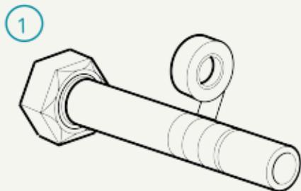
1 Envuelve la tubería de agua con **cinta aislante**, donde se instalará el Anillo de Merus.
